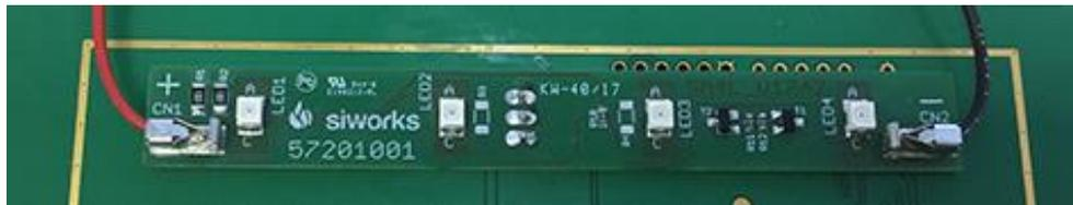
Abb. 1: Indikatorprint auf Flurlampe angeschlossen
